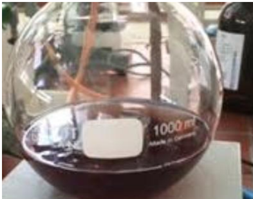
Slika 2: Ekstrakcija iz borovnic s hladnim topilom - metanolom.
