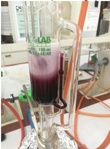
Slika 1: Ekstrakcija po Soxhletu iz borovnic s polarnim topilom - metanolom.
